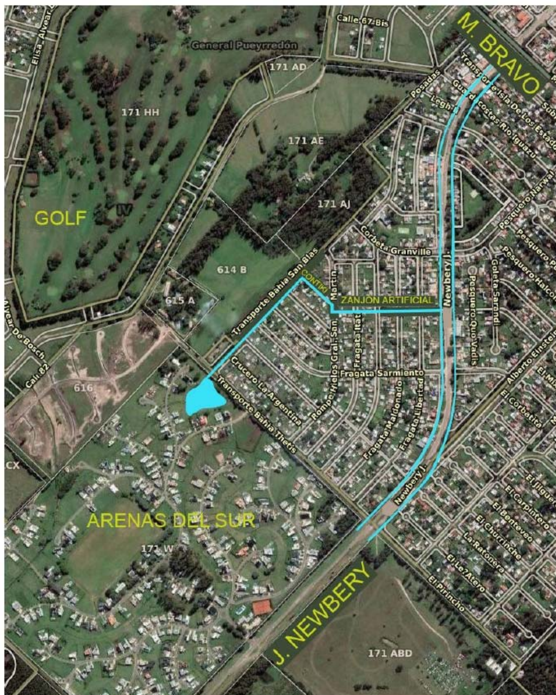
IMAGEN 1. ZANJÓN ARTIFICIAL A CIELO ABIERTO.
